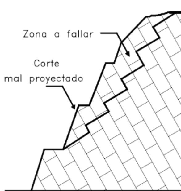
Figura 12 El volteo puede generar un desmoronamiento del talud o falla en escalera.
