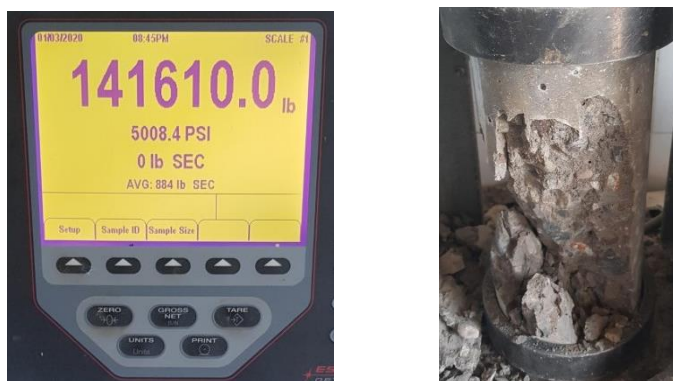
Figura No. 39: Ruptura de cilindro del Cemento GU Ultracem.
