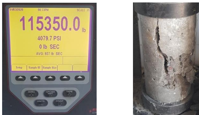
Figura No. 37: Ruptura de cilindro del Cemento GU América.
