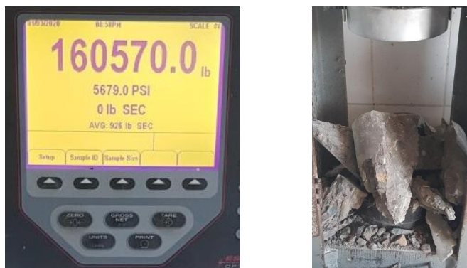
Figura No. 40: Ruptura de cilindro del Cemento GU Wan Png.
