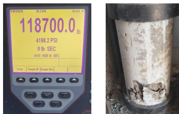
Figura No. 35: Ruptura de cilindro del Cemento GU Eco Argos.
