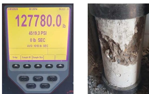
Figura No. 36: Ruptura de cilindro del Cemento GU Bijao.
