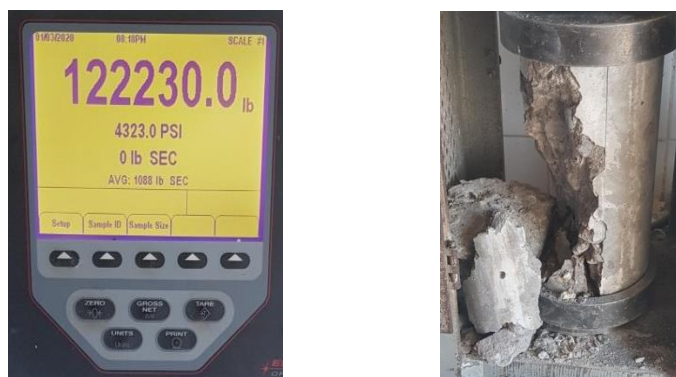
Figura No. 34: Ruptura de cilindro del Cemento GU Argos.
