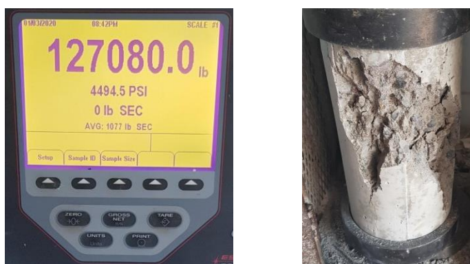
Figura No. 38: Ruptura de cilindro del Cemento GU Eco Ultracem.
