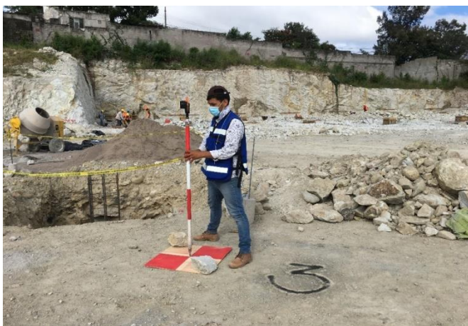
Ilustración 29: Ubicación georreferenciada de punto de control n°3 para ortofotos
