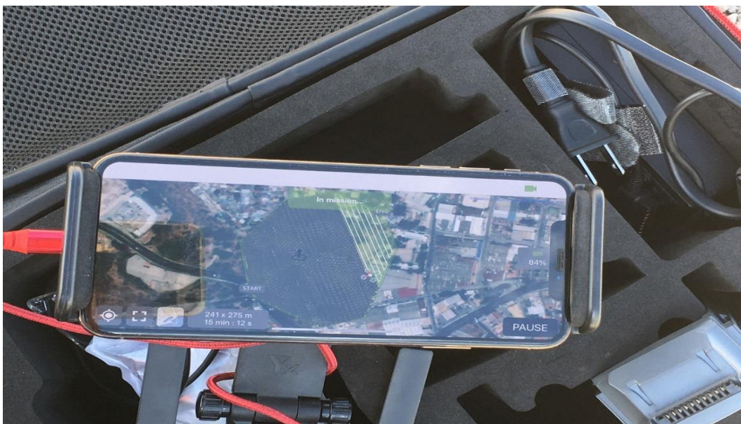
Ilustración 31: Verificación de avance y toma de ortofotos previamente marcadas en el plan de vuelo
