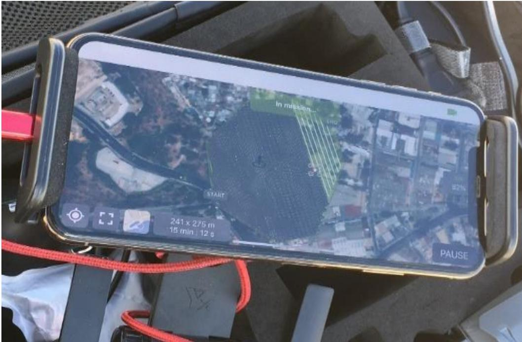
**NOTA:** Control del plan de vuelo georreferenciado del RPA, haciendo uso de la plataforma de DJI y PIX4D CAPTURE.
