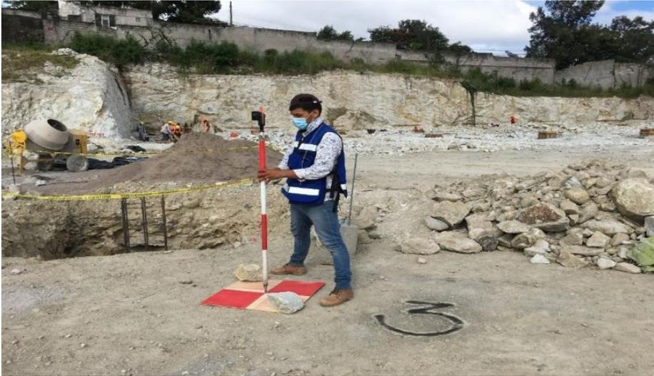
*NOTA: Cadenero utilizando prisma para la georreferenciación de puntos de control (PCs) durante el levantamiento topográfico con Estación Total. Fuente propia. Col. Las Torres, Comayagüela; Honduras. 7 de Noviembre del 2021.*
