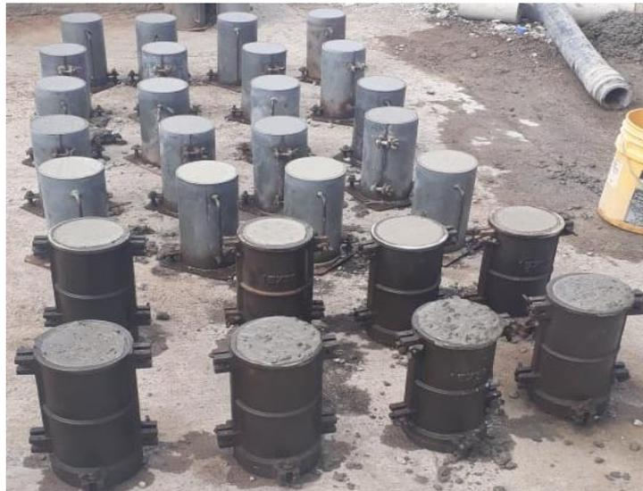
**Figura No. 28:** Cilindros de Muestra II.
